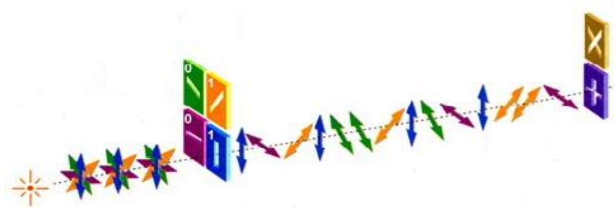
Figura 1.4. Polarizarea liniar-diagonală a fotonilor
