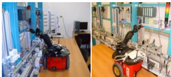
Fig. 25. Linia mecatronica HERA & Horstmann deservită de RM- Pioneer 3DX
