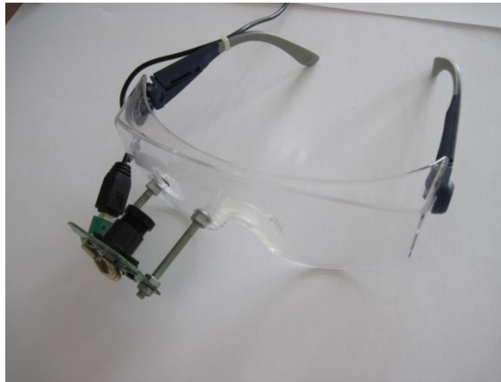
Figura 2. Sistemul de prinderea a camerei web de ochelari
