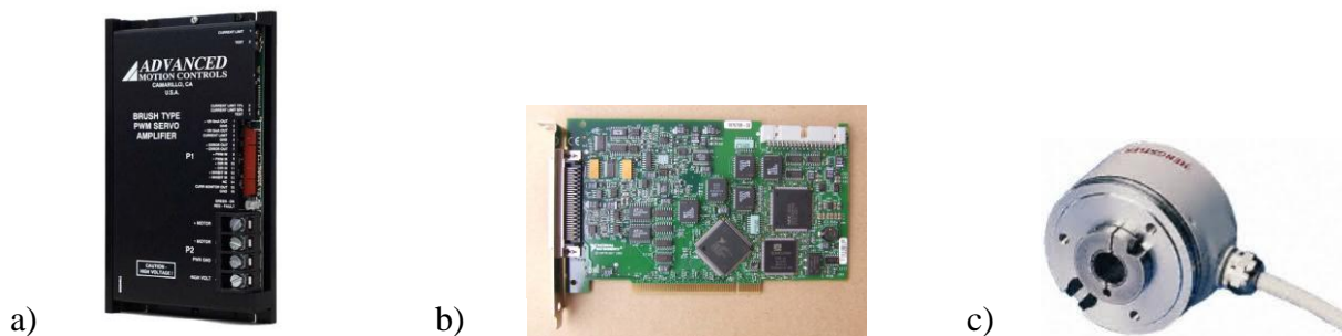
Figura 2. a) servoamplificatorul 50A8, b) placă de achiziție de tip NI-6024E, c) Encoder incrementl Hengstler RI-58
