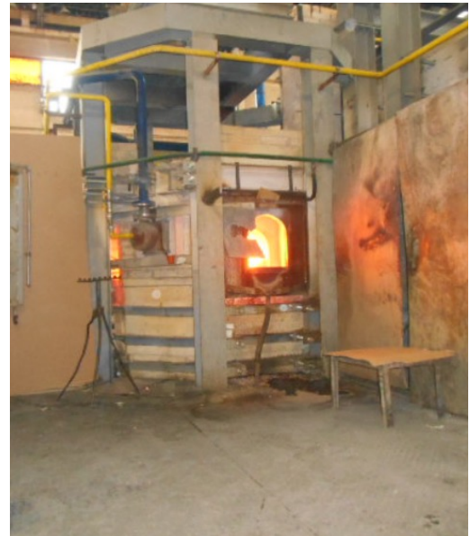
Fig.32 Gura pentru extragerea sticlei
