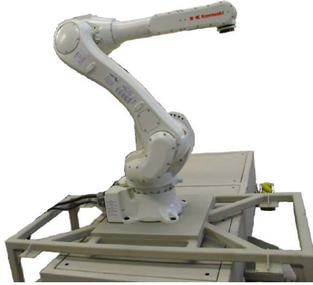
Fig. 35 Ansamblul vehicul – brat robotic
