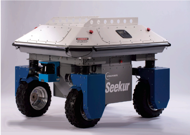
Fig. 2. Vehiculul multidirecțional SEEKUR
