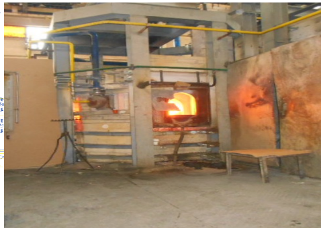
Fig. 9 Gura pentru extragerea sticlei
